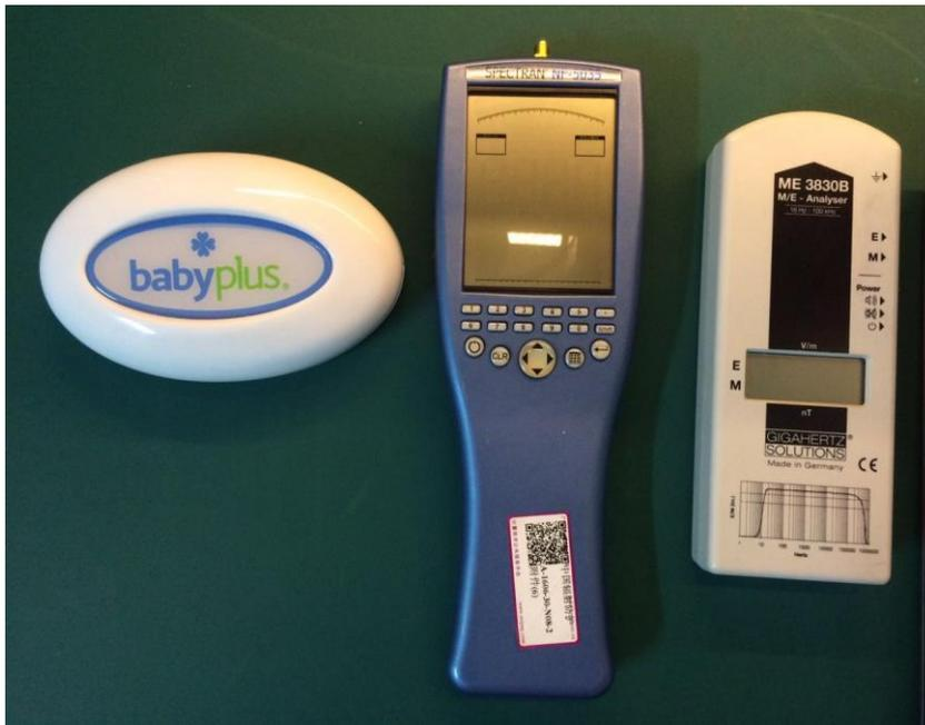
NF-5035 电磁辐射分析仪（频谱仪） 频率范围：1Hz-1MHz
