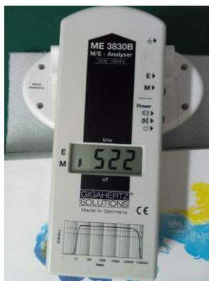
使用 ME3830B 测试 , 测量数值变化浮动非常大 , 跳动范围在满量程至 300nT 不停跳动 , 相片数值为某一时刻的数值。因为跳动范围相似故不全部列出测量图片。
